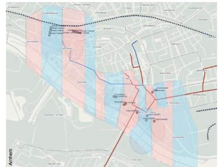
*Le plan d'ensemble pour le stockage chaud/froid – zones bleu clair pour le stockage du froid et rouge clair pour le chaud – pour le centre-ville d'Arnhem permettra d'utiliser au mieux la capacité disponible.*
